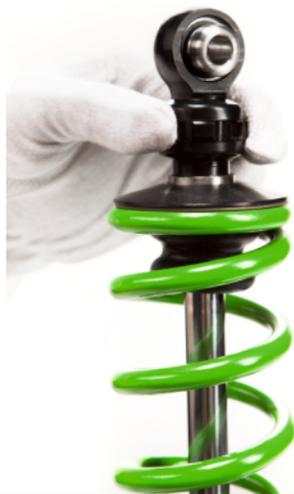
Рекомендуем начинать тесты в среднем положении регулировки, далее опробовав крайне мягкие и крайне жесткие настройки и выбрав подходящие. Наилучшими настройками сжатия-отбоя является компромисс между максимальной сцеплением колеса с трассой и отсутствием вторичных клевков и отскоков квадроцикла от трассы.
